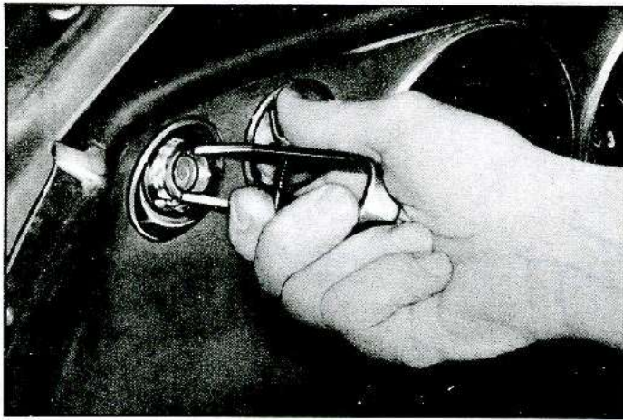
Fig. 12—Removing Bezel Nut
