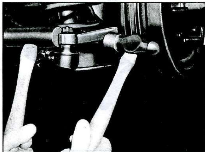
Fig. 23—Freeing Ball Stud
