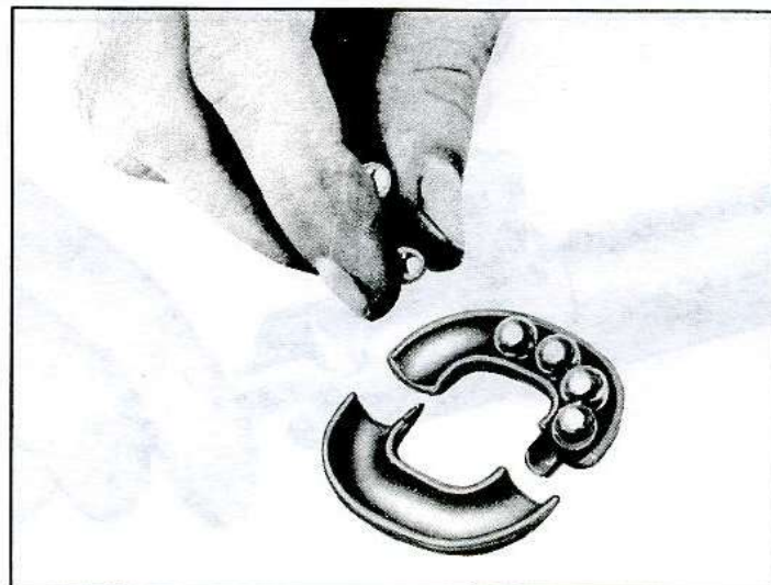
Fig. 14—Filling Ball Guides
