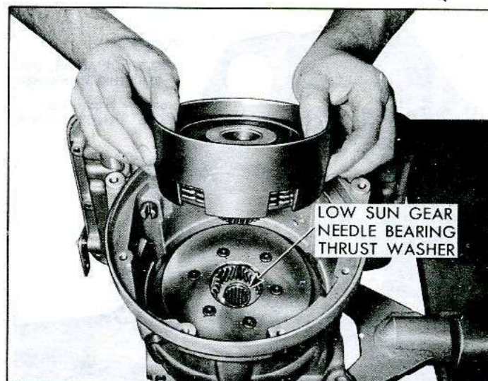
Fig. 7E-54—Installing Clutch Drum
