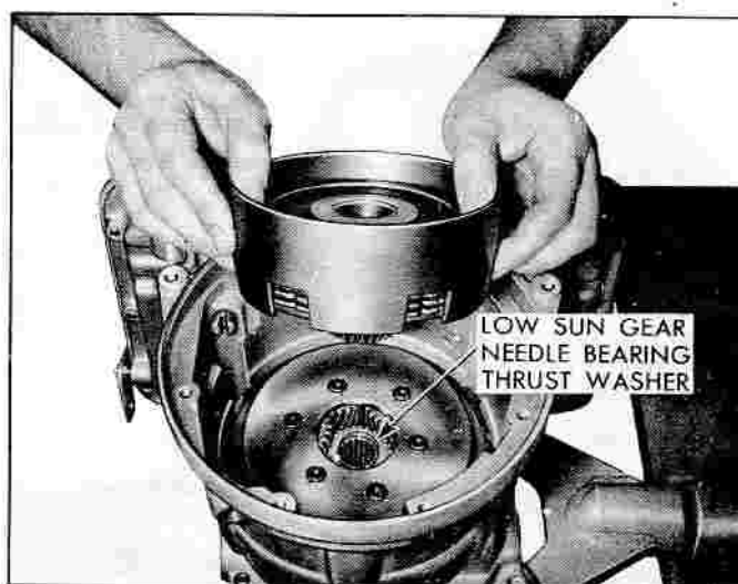
Fig. 7E-54—Installing Clutch Drum
